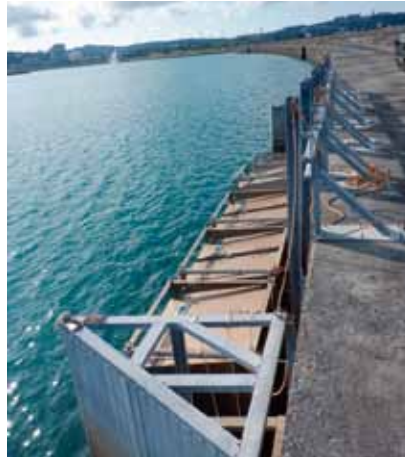
世界初となる小型水力発電機の量産化実証実験中(与那原マリナ岸壁)
