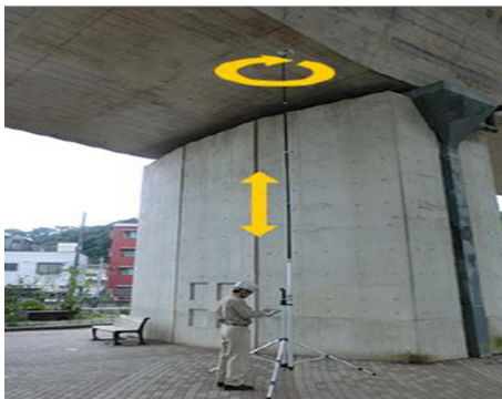
写真-1【橋梁点検ロボットカメラ】
