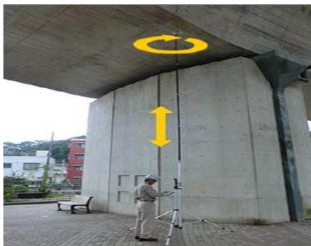
写真-1【橋梁点検ロボットカメラ】
