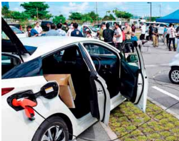
▲ PHV(プラグインハイブリッド車)は、車両で発電した電気を家庭用電源として災害時などに活用することができる
