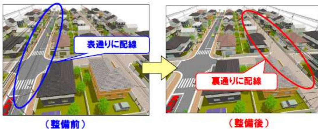
図-5 裏配線方式イメージ図(出典:国土交通省HP)
